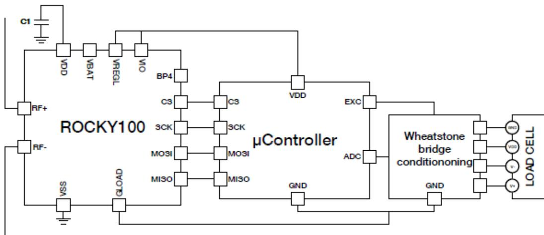
ROCKY100 芯片包括 RF 前端用于 UHF RFID 能量收集和通讯，一个用于生成所需电压水平的供电模块，一个符合 EPC C1G2/ISO18000-6C 标准的数字处理器，该数字处理器包括 SPI 电桥。可以通过 EPC C1G2 标准内存访问命令控制 SPI 电桥。
